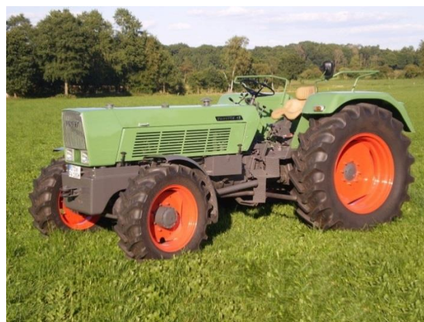
Fendt Favorit-3 S en 4 S, ze zijn beiden uitgerust met vierwielaandrijving als Favorit-3 SA en 4 SA
