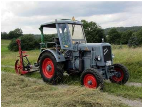
De Fendt Dieselross F-22 VZ is 24 cm langer dan de F-22.
