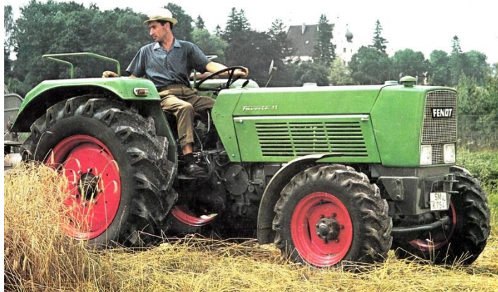
Fendt Favorit-3 S en 4 S, ze zijn beiden uitgerust met vierwielaandrijving als Favorit-3 SA en 4 SA
