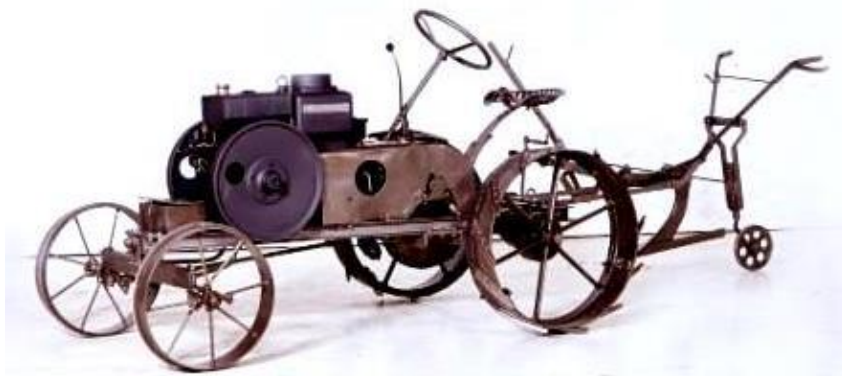
Het tweede exemplaar van Fendt heeft een vermogen van 6 á 7 pk.
