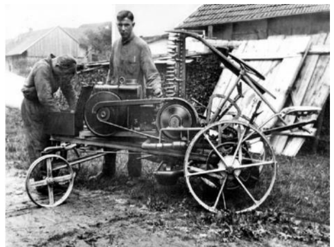
De eerste motormaaier van Fendt heeft een vermogen van 4 pk.
