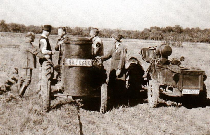
Prototype 113-3 met een houtgasgenerator
