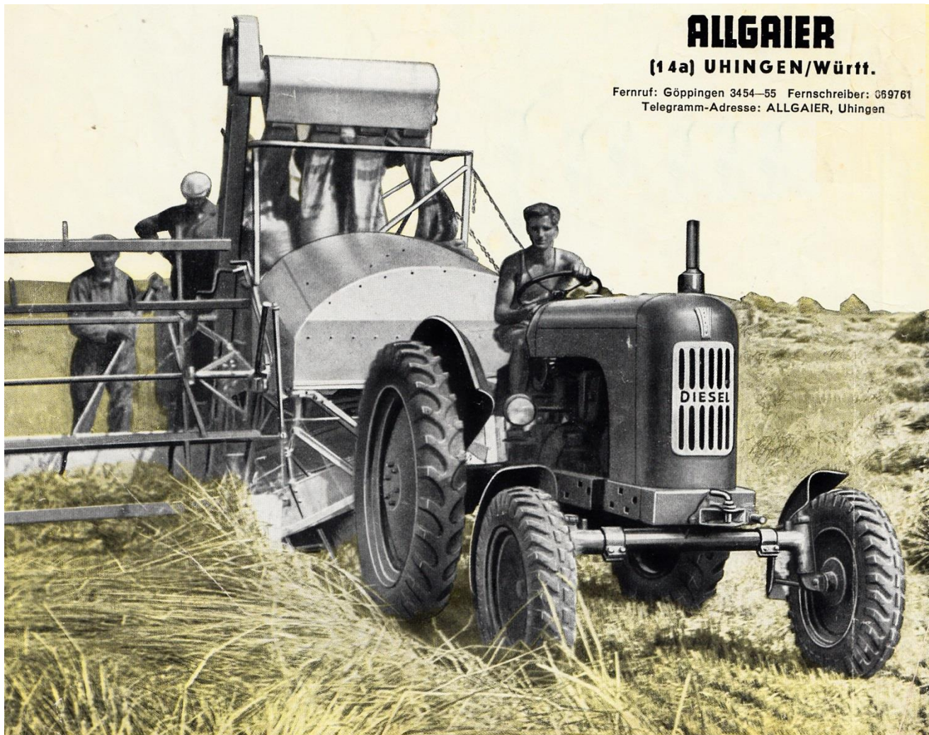
Een Allgaier A-40 is al in staat om een getrokken maaidorser te trekken
