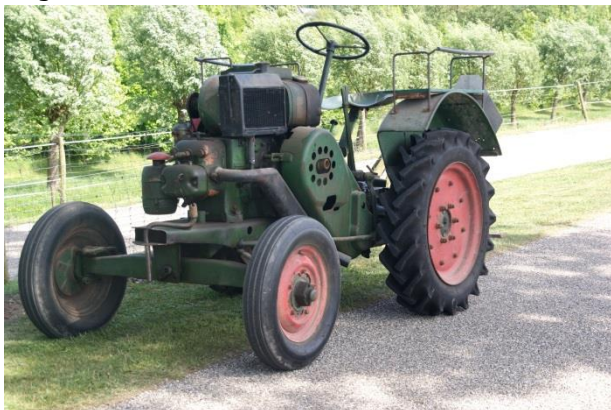
In tegenstelling tot eerdere A-typen heeft de A-24 een radiator
