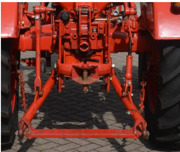
De rijafhankelijke aftakas is een aparte as die ook dienst doet als handrem. Zie boven de band rond de as.
