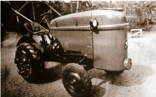
Prototype 113 met 12pk Reihemotor.
