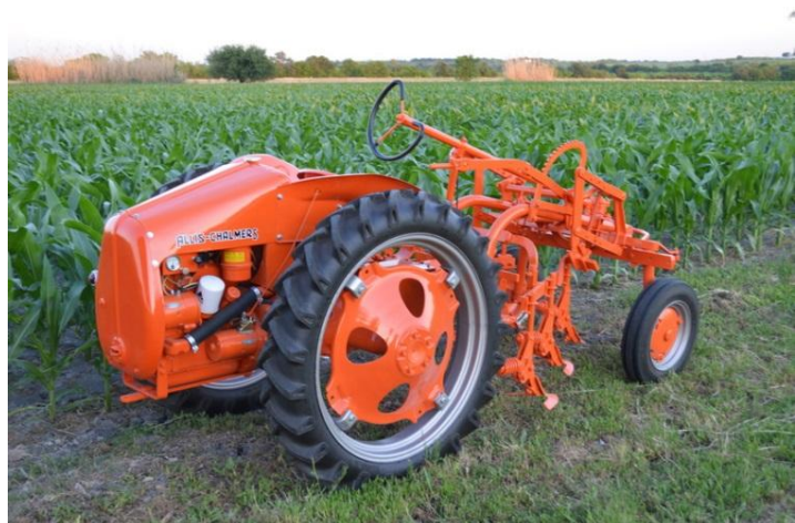
Allis-Chalmers G de motor zit boven de achteras
