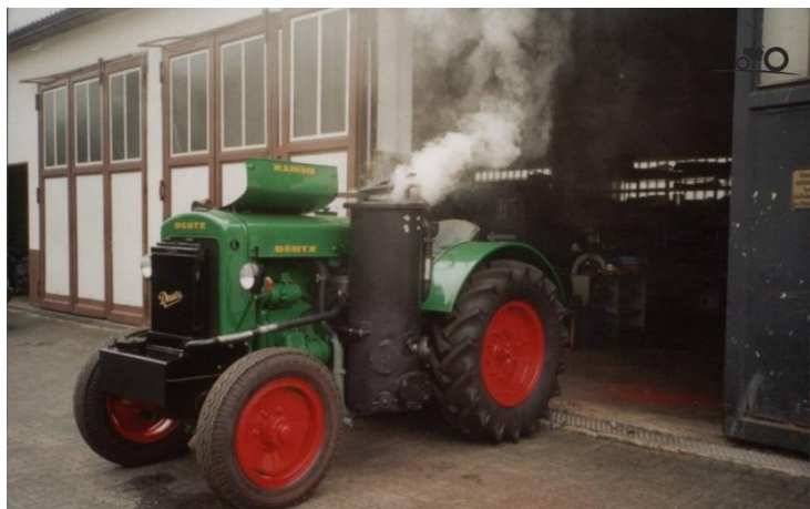
Deutz F2M-315 met houtgasgenerator
