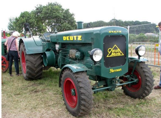
Omgebouwde Deutz F3M-317, nu met een Deutz motor type A8M-517
