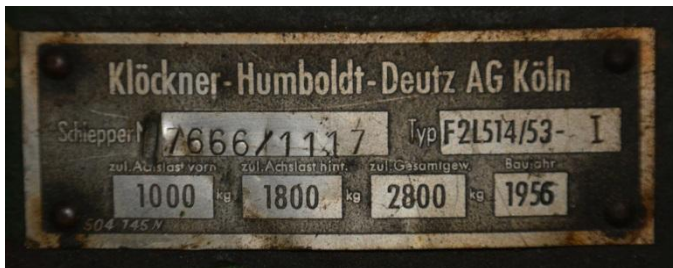
Dit type F2L-514 /53 is gebouwd in 1956. Het getal 53 geeft het jaar aan waar in de productieperiode van dit type is gestart.
