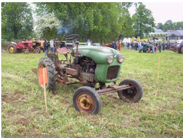
Vierzon 203 S met een Peugeot benzine motor
