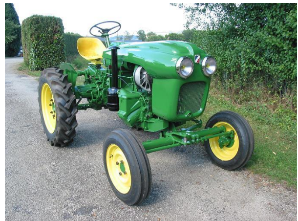
Vierzon 203 D met een Normag dieselmotor
