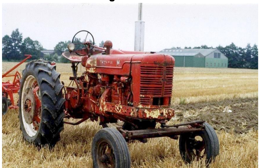
In ons land kon als de motor van een Farmall M te licht werd bevonden of versleten was de M worden voorzien van een Perkins dieselmotor van rond de 50 pk.
