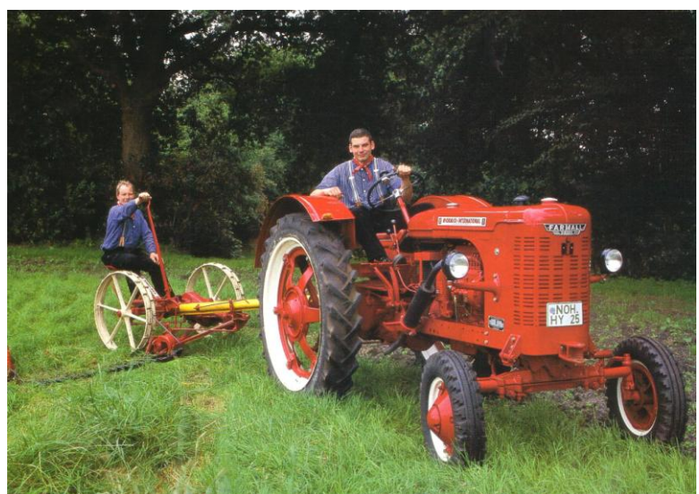
Farmall DF-25 met de eerste eigen dieselmotor van IHC Zonder het benzine/diesel startstelsel.
