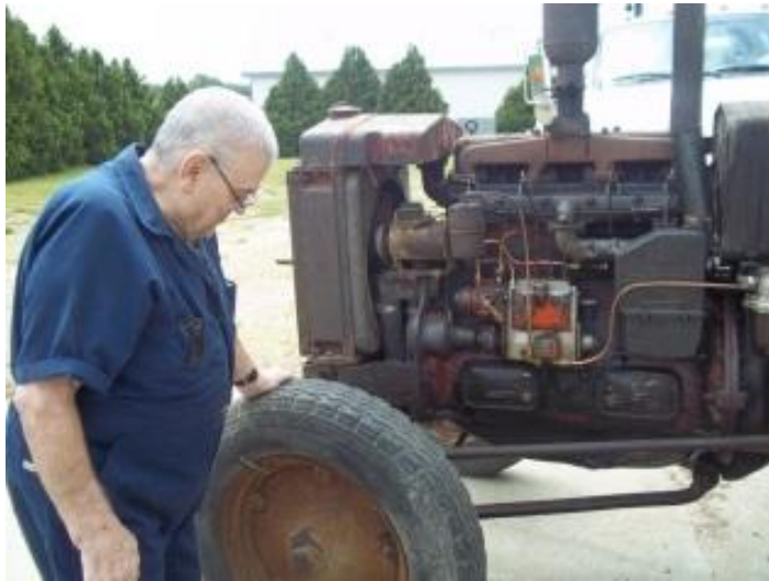
Case L met het Hesselman systeem, waarschijnlijk later aangebracht want volgens de gegevens was het Hesselman systeem pas leverbaar (1942) toen de L al uit de productie was genomen.
