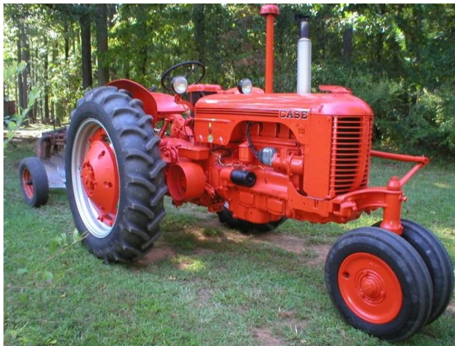
Case DC/ DC-3 met een smalle vooras
