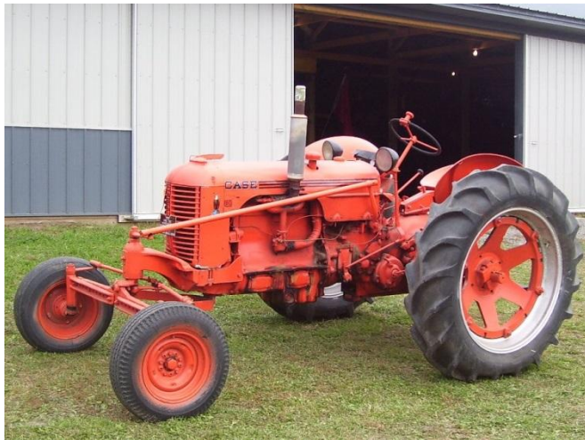
Case DC/ DC-3 met een brede vooras.
