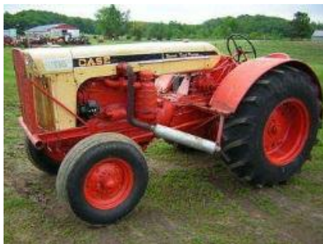
Case 734 in twee verschillende uitvoeringen. Ze werden zowel in de fruitteelt als in de wijnbouw gebruikt.
