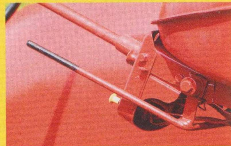
■ La commande d'accélérateur est manuelle sur le Cockshutt 30. Elle est représentée par ce simple levier en acier, situé à droite de la console de bord.
