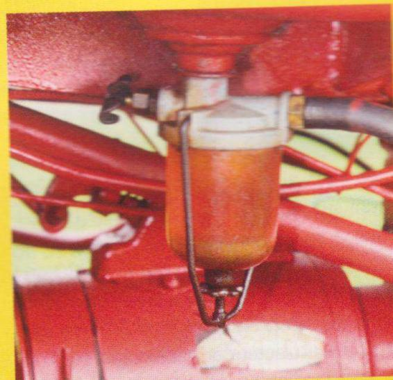
■ Le réservoir dispose sur sa partie inférieure d'un robinet d'alimentation en laiton et d'un filtre décanteur muni d'un bocal en verre, comme nombre de tracteurs nord-américains de l'époque.
