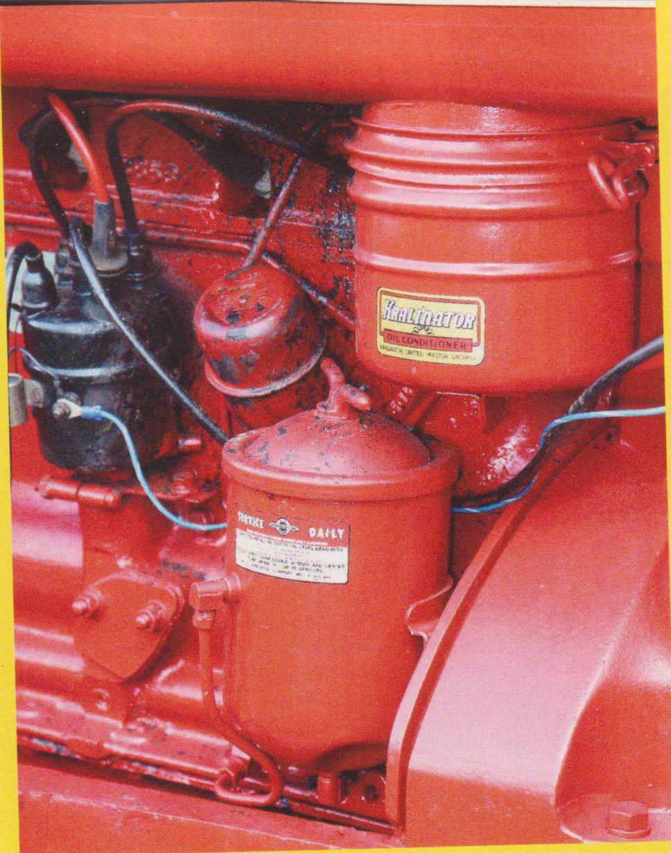
■ Zoom sur les différents accessoires figurant à l'arrière gauche du 4 cylindres. Disposé verticalement, l'allumeur est situé à gauche de la goulotte de remplissage en huile moteur. Disposant d'un système à peigne, le filtre à huile est fabriqué par Donaldson. Il est placé en contrebas du filtre à air à bain d'huile issu de la gamme spécialisée Kralinator.
