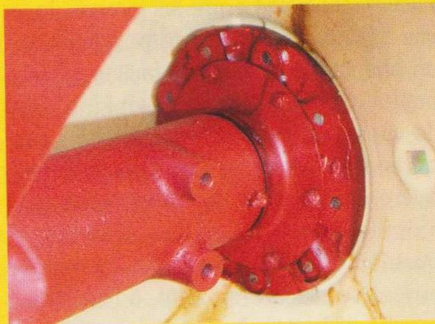
■ Usinées en fonte d'acier, les trompettes de pont disposent de points de fixation aidant à l'attelage d'outils portés et semi-portés arrière et sous châssis.
