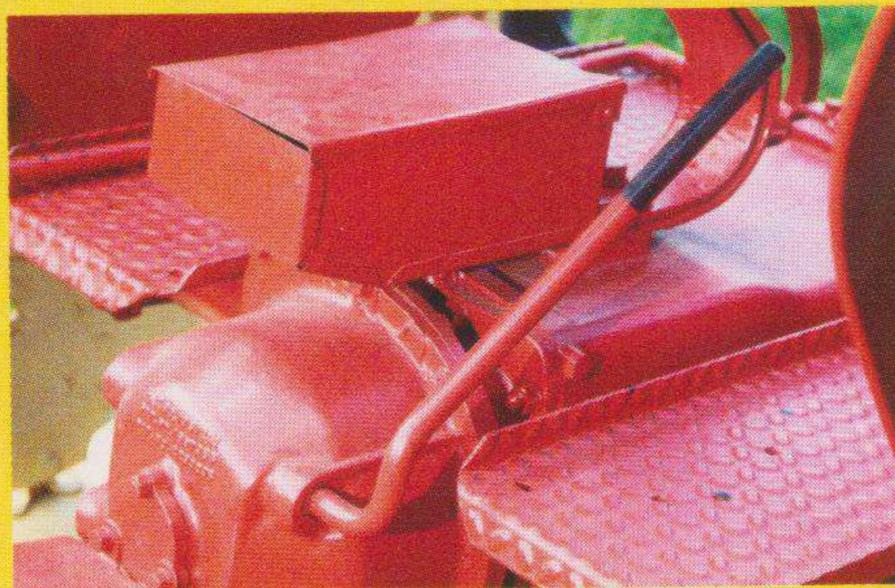
■ **La caisse à outils rectangulaire du tracteur se trouve à l'aplomb du siège conducteur. Réalisé en acier, le levier d'enclenchement de la prise de force indépendante est positionné à sa droite.**
