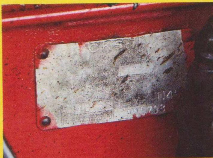
■ Réalisée en aluminium, la plaque constructeur est fixée en quatre points sur le côté gauche du bloc-moteur, à proximité de l'allumeur.
