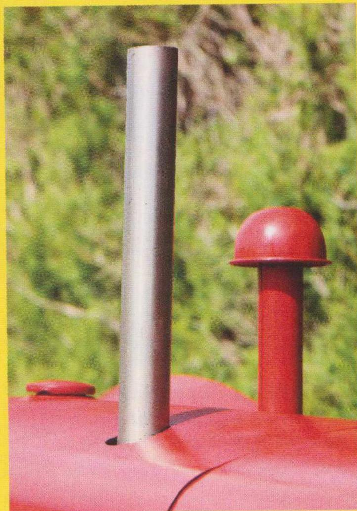
■ Disposés verticalement, l'échappement et la cheminée d'aspiration du filtre à air traversent tous deux la partie supérieure du capot moteur.
