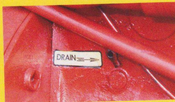
■ La vis de purge du bloc-moteur se situe à l'arrière droit de ce dernier, à proximité de la colonne de direction. L'emplacement de cette vis est rappelé par un autocollant rectangulaire à dominante ivoire.
