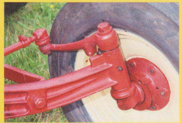
■ *Tout en courbes, la face avant du tracteur reflète un certain esprit avant-gardiste. La calandre est agrémentée de fines barres horizontales du plus bel effet, accentuant largement le passage de l'air pour un meilleur refroidissement du radiateur et du compartiment moteur. Monté sur balancier, l'essieu avant est réalisé en fonte d'acier. À noter: ni les voies avant, ni les voies arrière ne sont réglables sur ce tracteur de type standard.*
