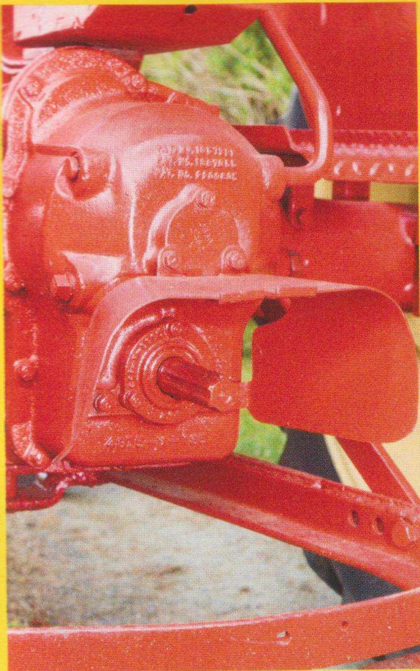
■ **Le Cockshutt 30 est le premier tracteur agricole de série à avoir bénéficié d'une prise de force indépendante. Notez que l'arbre à 6 cannelures dispose d'un carénage supérieur en tôle d'acier favorisant l'utilisation de cet accessoire en toute sécurité.**
