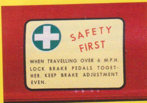
■ L'aspect de la sécurité était primordial pour le constructeur. Disposé à droite, sur le flanc du réservoir de carburant, cet autocollant stipule que les pédales de frein se doivent d'être jumelées lorsque le tracteur évolue à une vitesse supérieure à 6 miles à l'heure (9,66 km/h).
