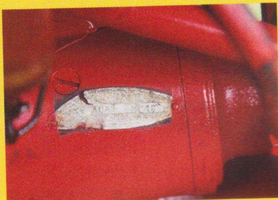
■ Notre tracteur disposait déjà à l'époque d'un démarreur électrique, placé à l'arrière du bloc-moteur, sous le réservoir de carburant. De marque Autolit, cet accessoire est estampillé d'une petite plaque ovale en aluminium rappelant sa marque et son type.
