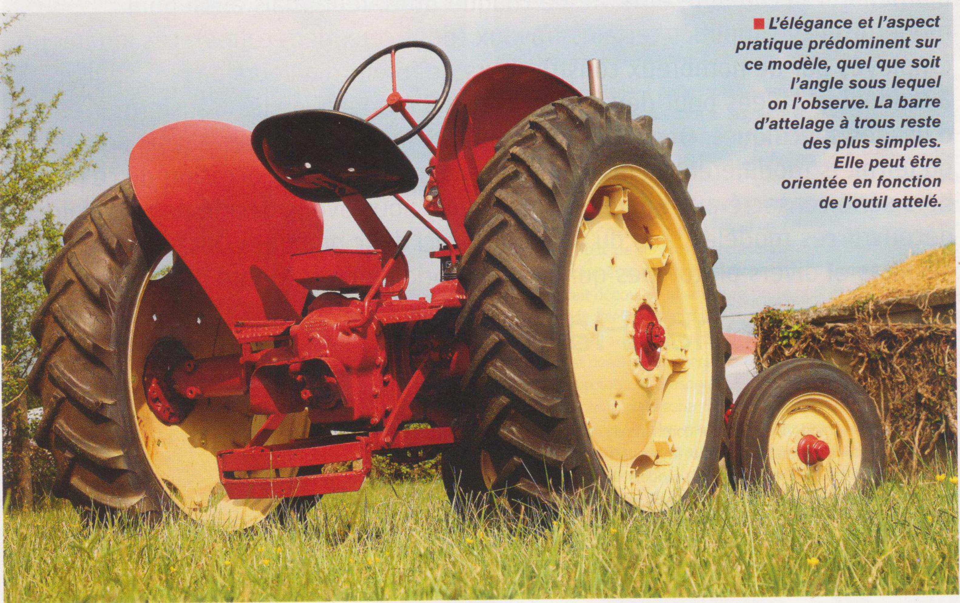
■ *L'élégance et l'aspect pratique prédominent sur ce modèle, quel que soit l'angle sous lequel on l'observe. La barre d'attelage à trous reste des plus simples. Elle peut être orientée en fonction de l'outil attelé.*
