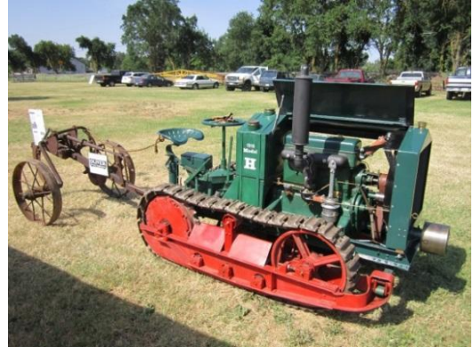
Goed zichtbaar de Weidleymotor van de H 12-20
