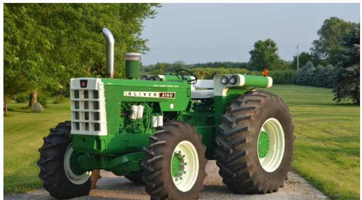
Oliver 2150 4WD (Hercules 6-cil dieselmotor)
