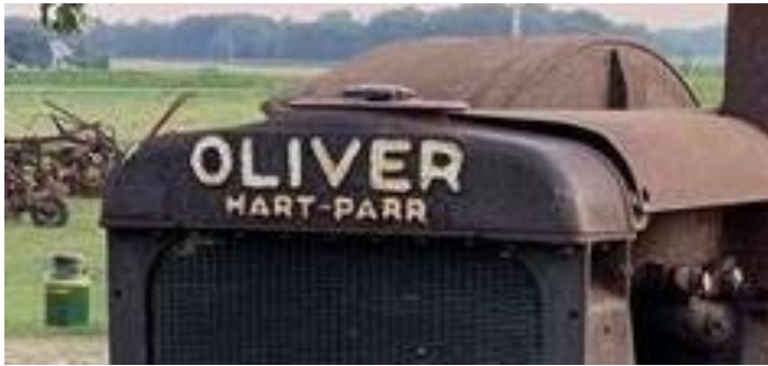
Tot 1934 stond de naam Hart-Parr met grote letters in de bovenste tank van de Radiateur gegoten. (foto rechts) Daarna werden de rollen omgedraaid en prijkte de naam Oliver met grote gegoten letters op de radiator. (foto links)
