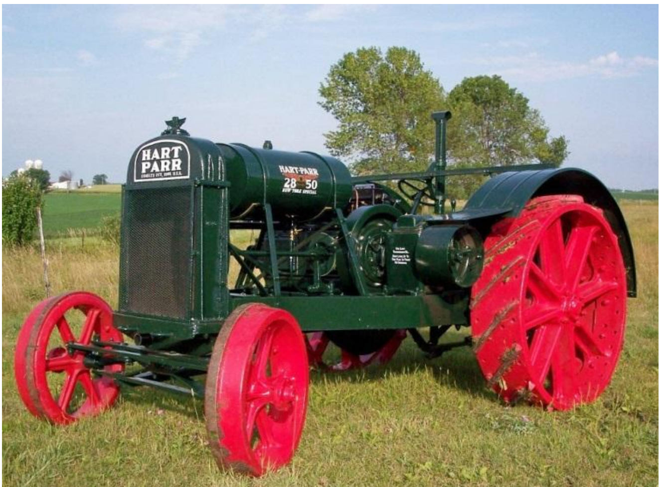
Hart-Parr 28-50 De modellen vanaf halverwege 1928 tot 1930 hebben een bredere radiator, net als hier op de foto.
