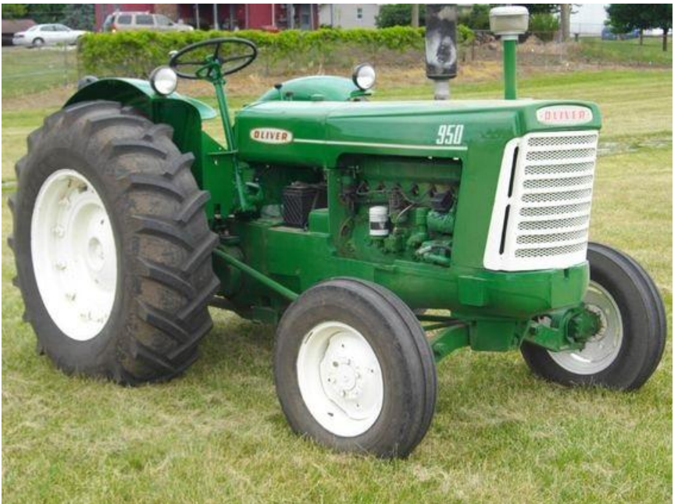
De Oliver 950 met een Waukesha benzinemotor.
