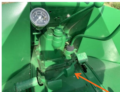
Het middelste pedaal is voor beide wielen. Pedaal rechts is voor het rechterwiel en pedaal links is voor het linkerwiel
