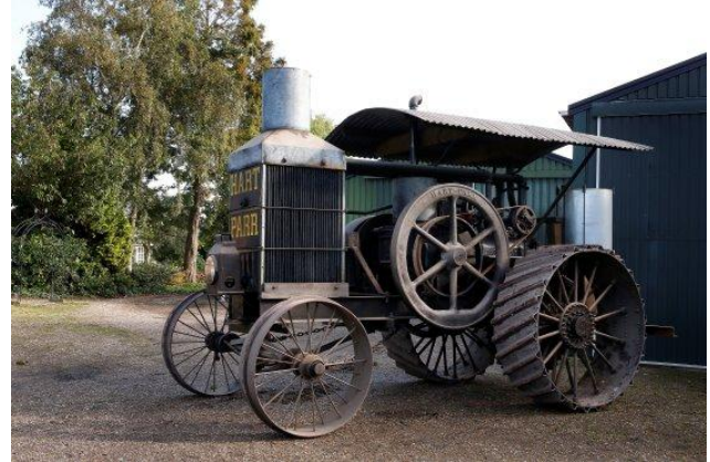
De tractoren die gebouwd werden waren herkenbaar aan de hoge koeltoren. De 22-40 werd gebouwd tussen 1903 en 1911. Vanaf 1908 werd hij vanwege de hogere compressie aangeduid als 22-45 (Foto)
