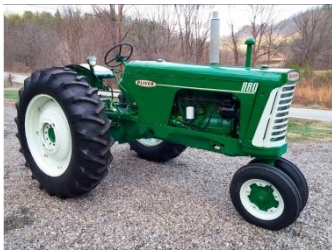
De Oliver 880 is er in verschillende uitvoeringen n.l. als Row-Crop small of wide front, Standard, zowel in diesel benzine of LPG
