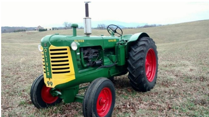
Oliver Super 99 met een 3-cil GM motor
