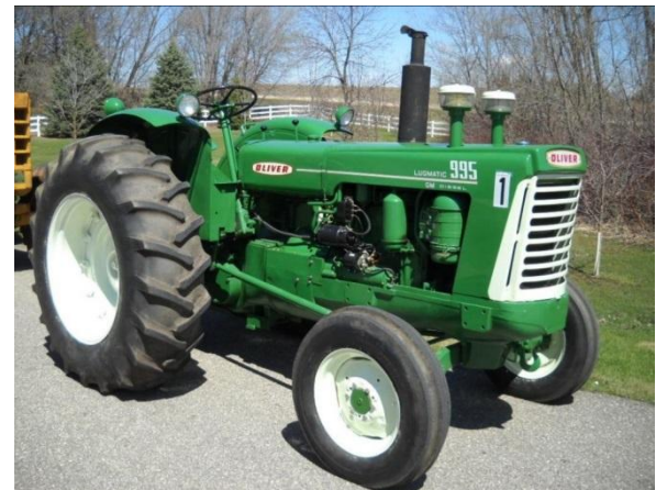
Oliver 990 en 995 Beide tractoren zijn uitgerust met een 3-cil GM dieselmotor
