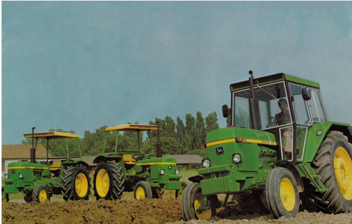
John-Deeres mechanische voorwielaandrijving.
