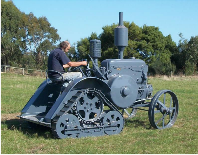
Lanz-Bulldog HR-2 met een halftrupsinstallatie van Ritcher.
