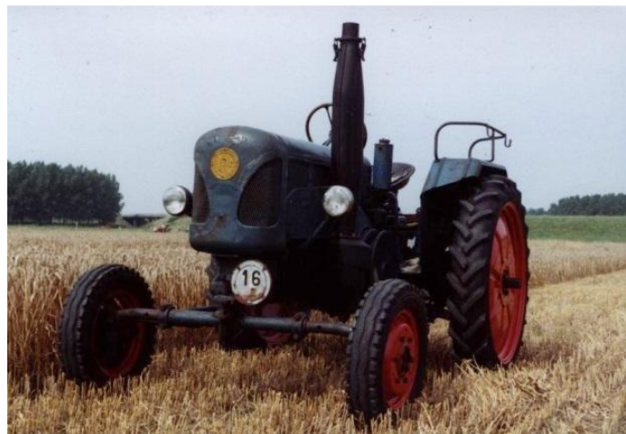
De D-2216 is dezelfde als de D-2016 alleen deze uitvoering met uitschuifbare assen is bestemd voor de export
