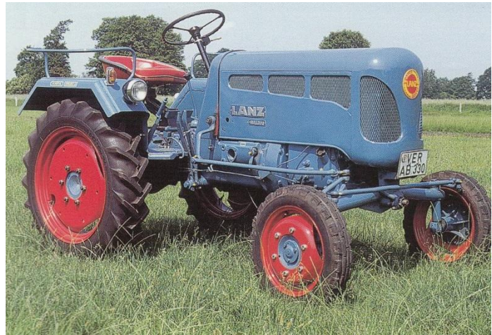
Lanz-Bulldog D-1266 en D-1666 voorzien van een watergekoelde MWM Motor uit de A-1806
