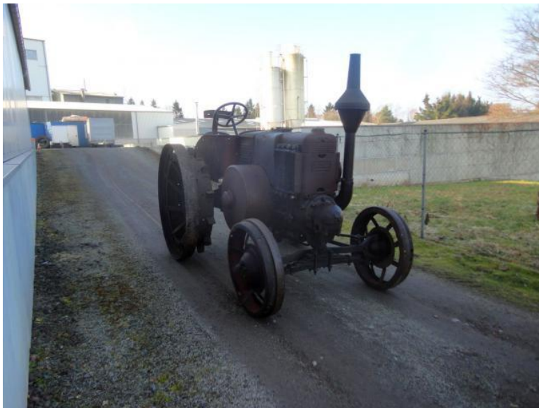
Het type 22-38 werd in 1934 vervangen door dit type Lanz Acker Bulldog D-9500 (HR-8) ook wel aangeduid als type 38
