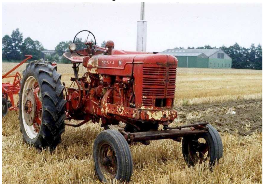
In ons land kon als de motor van een Farmall M te licht werd bevonden of versleten was de M worden voorzien van een Perkins dieselmotor van rond de 50 pk.
