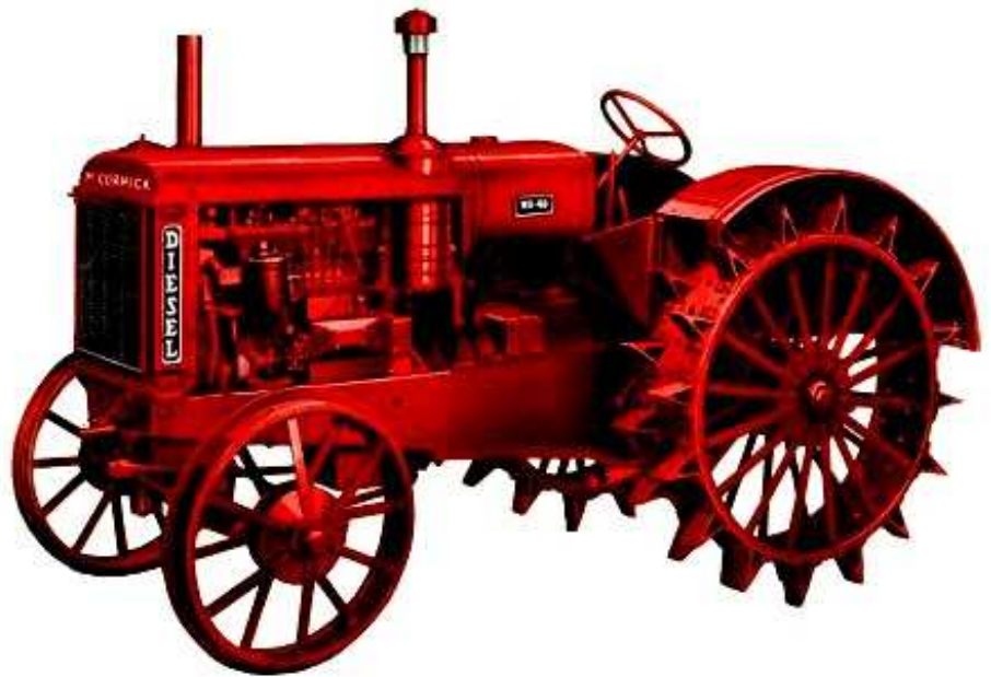
Mc Cormick Deering WD-40 met een 4-cil dieselmotor Deze wordt gestart op benzine.
